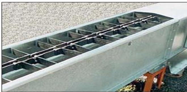
Figura 4: Transportador de corrente
