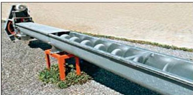
Figura 6: Transportador helicoidal
