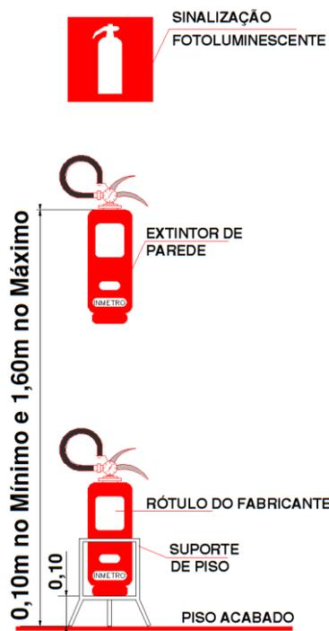
**Figura 3: DETALHE DE FIXAÇÃO E SINALIZAÇÃO DO EXTINTOR**
