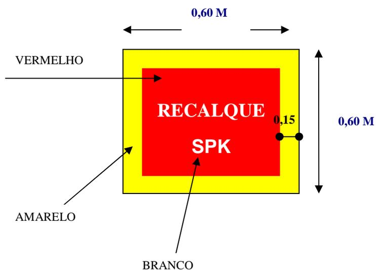
**OBSERVAÇÃO: O REGISTRO DE RECALQUE DO SISTEMA DE HIDRANTES DEVERÁ SER SINALIZADO DA MESMA FORMA ACIMA, PORÉM SUBSTITUINDO-SE AS LETRAS "SPK" POR "HID".**
