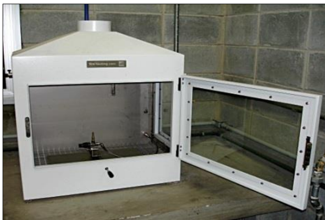
Figura 34: Determinação da ignitabilidade dos materiais.
