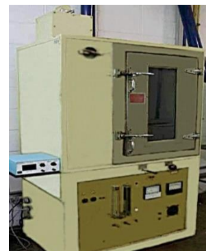
Figura 31: Câmara de densidade óptica fechada.
