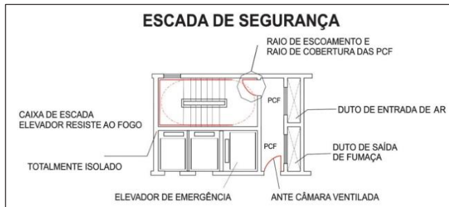
Figura 40: Escada e elevador à prova de fumaça.
