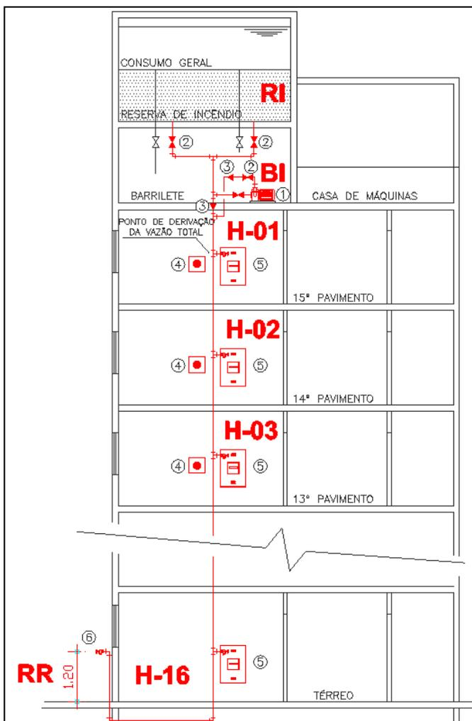
**Figura C.5:** Esquema de instalação de bomba de reforço abastecendo os pontos de hidrantes ou mangotinhos mais desfavoráveis considerados no cálculo, por uma só prumada
