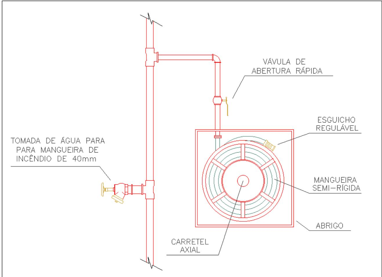
**Figura A.1:** Exemplo de instalação de sistema de mangotinho com válvula globo angular na prumada, para emprego pelo Corpo de Bombeiros Militar, em caso de uso do dispositivo de recalque da edificação.
