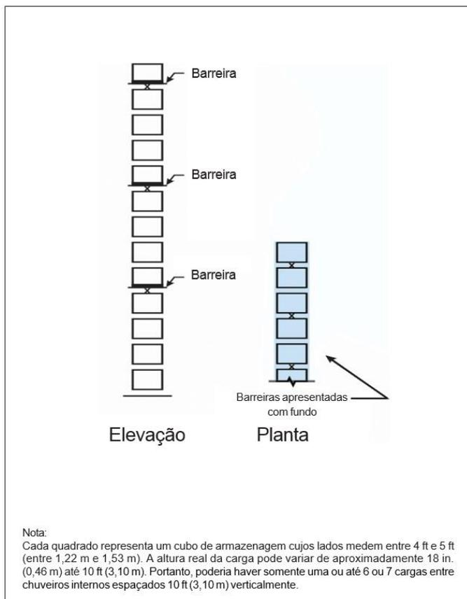
**Figura 5.3.4.4.1.2(c):** Distribuição de chuvaeiros internos, mercadorias Classe I, Classe II ou Classe III, estruturas porta-paletes simples, altura de armazenagem acima de 7,6 m (25 ft) – **Opção 2.**
