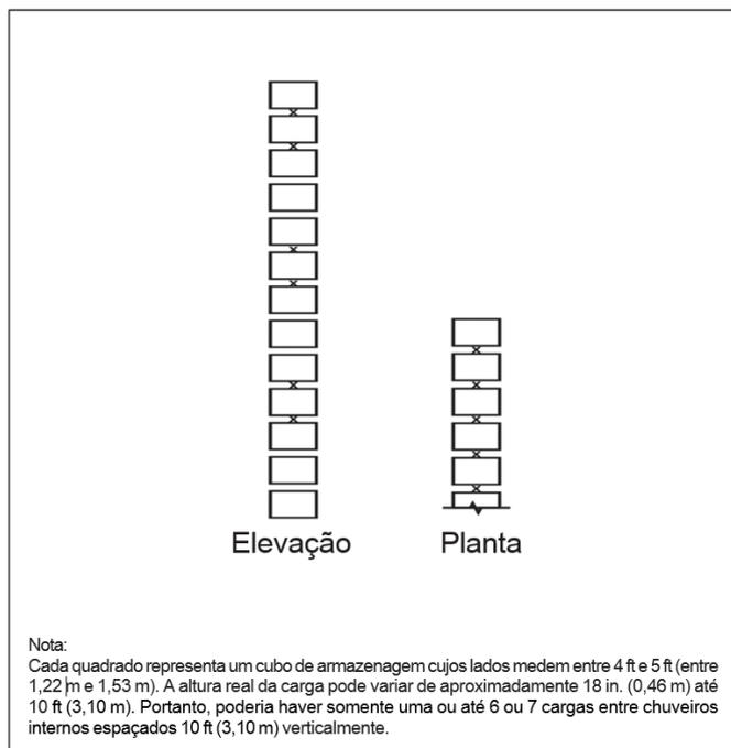
**Figura 5.3.4.4.1.2(b):** Distribuição de chuvaeiros internos, mercadorias Classe I, Classe II ou Classe III, estruturas porta-paletes simples, altura de armazenagem acima de 7,6 m (25 ft) - **Opção 1.**
