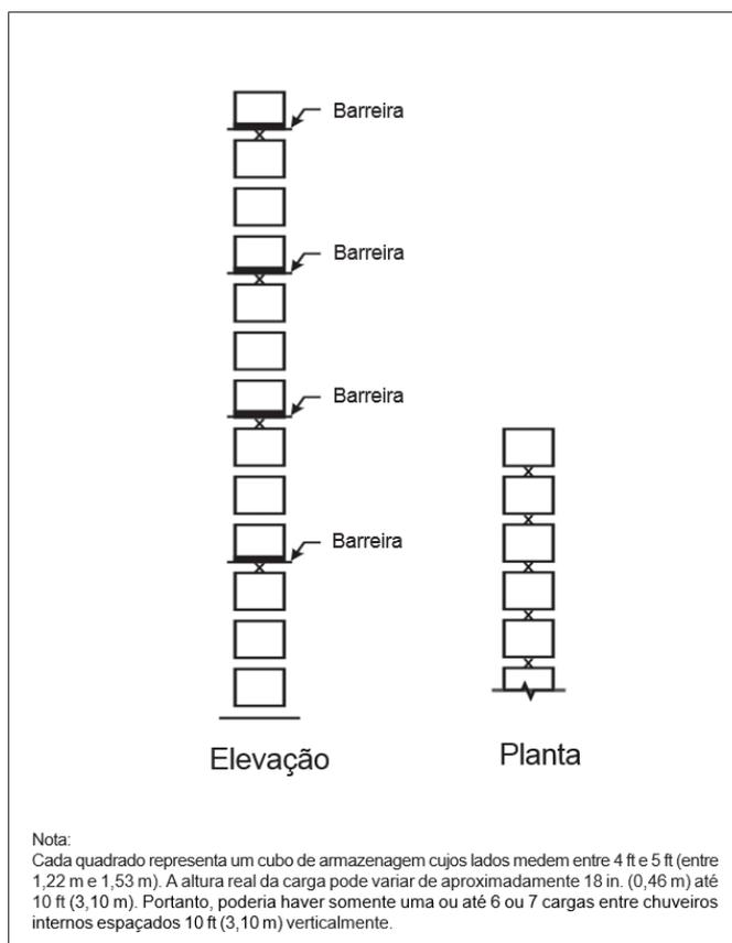
**Figura 5.3.4.4.1.2(d):** Distribuição de chuvaeiros internos, mercadorias Classe I, Classe II, Classe III ou Classe IV, estruturas porta-paletes simples, altura de armazenagem acima de 7,6 m (25 ft) – **Opção 2.**
