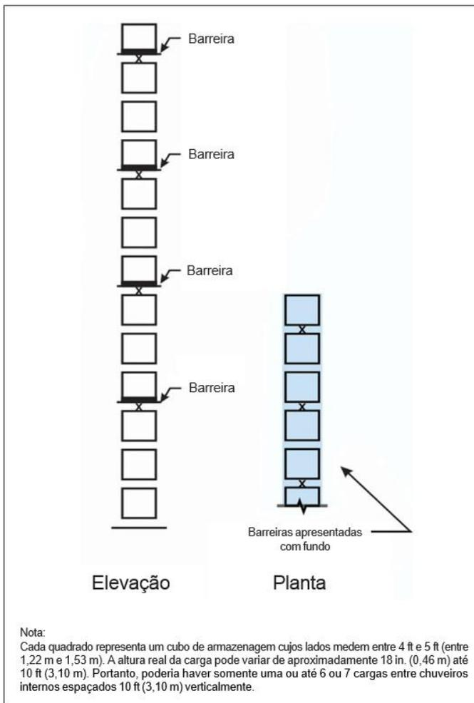
**Figura 5.3.4.4.1.2(e):** Distribuição de chuveiros internos, mercadorias Classe I, Classe II, Classe III ou Classe IV, estruturas porta-paletes simples, altura de armazenagem acima de 7,6 m (25 ft) – **Opção 3.**
