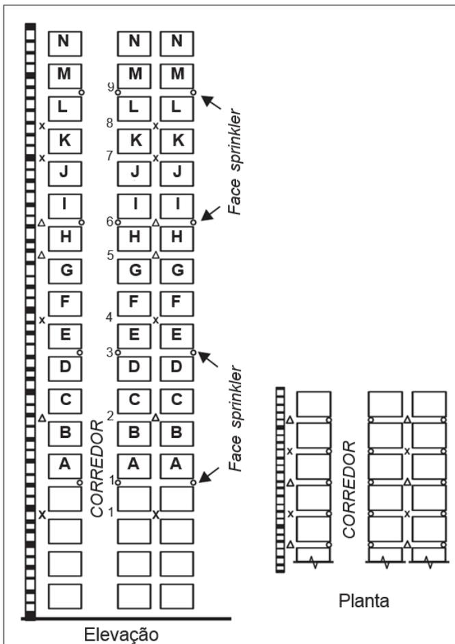
**Figura 5.3.4.4.1(h):** Distribuição de chuveiros internos, mercadorias Classe I, Classe II, Classe III ou Classe IV, altura de armazenagem acima de 7,6 m (25 ft) – **Opção 1.**
