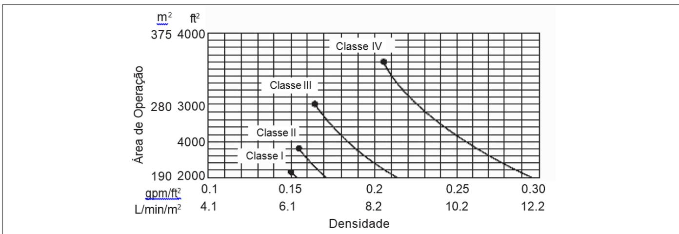
**Figura 5.2.2.1.5.2:** Curvas de projetos de sistemas de chuveiros, armazenagem a 6,1 m (20 ft) de altura – chuveiros de temperatura alta.
