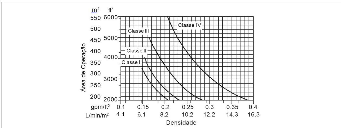
**Figura 5.2.2.1.5.1:** Curvas de projetos de sistemas de chuveiros, armazenagem 6,1 m (20 ft) de altura – chuveiros de temperatura normal.
