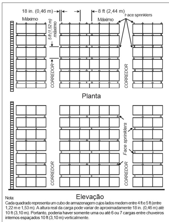
**Figura 5.3.5.4.1.3(f):** Distribuição de chuveiros internos, plásticos em caixas de papelão e plásticos não expandidos, estruturas porta-paletes múltiplas, altura de armazenagem acima de 7,6 m (25 ft) – **Opção 4** [(Espaçamento máximo de 1,5 m (5 ft))]
