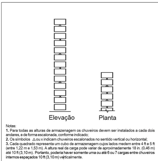
**Figura 5.3.4.4.1.2(a):** Distribuição de chuvaeiros internos, mercadorias Classe I, Classe II, Classe III ou Classe IV, estruturas porta-paletes simples, altura de armazenagem acima de 7,6 m (25 ft) – **Opção 1.**
